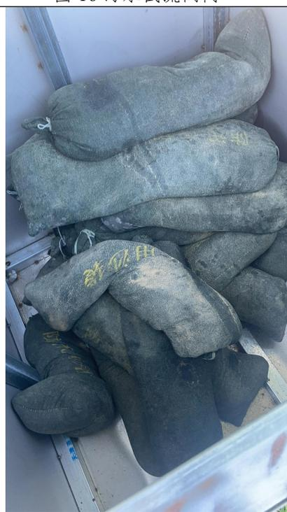
图 18 雨水排口应急沙袋
