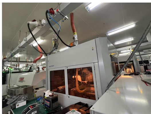
烧结电源针线：贴装 Power Pin 铜柱
