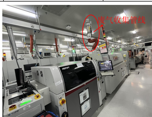
芯片烧结线：银浆印刷、银浆固化
