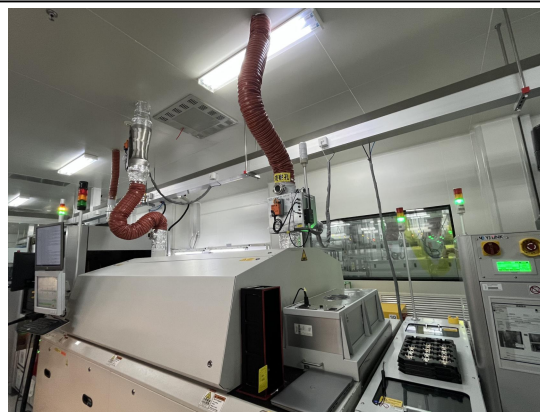
烧结电源针线：银浆固化
