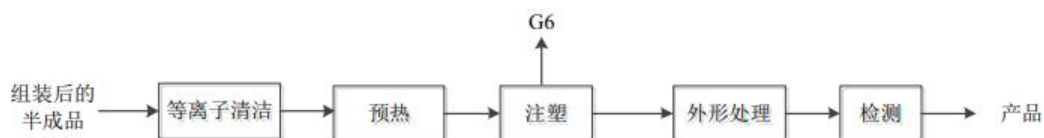
图 3.4.11-4 变速箱控制单元 DQ 381 CFD 注塑生产工艺流程图
