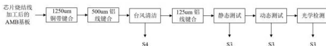
图 3.4.9-2 新功率模块键合线生产工艺流程图
