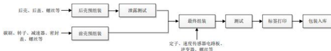
图 3.4.6-3 终产品 EMS3 电机生产工艺流程图
