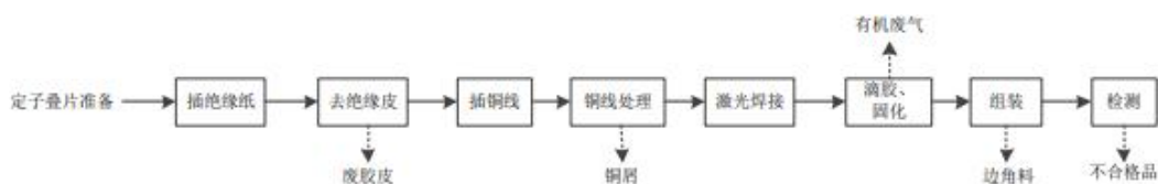
图 3.4.10-1 新能源汽车零部件定子生产工艺流程图
