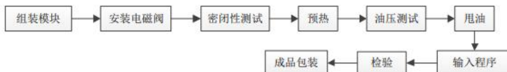
图 3.4.2-1 变速箱电子液压控制模块生产工艺流程图
