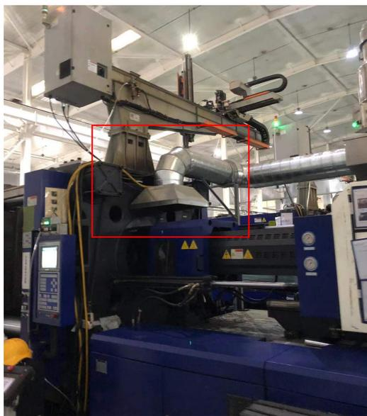
新增注塑工序废气集气罩
